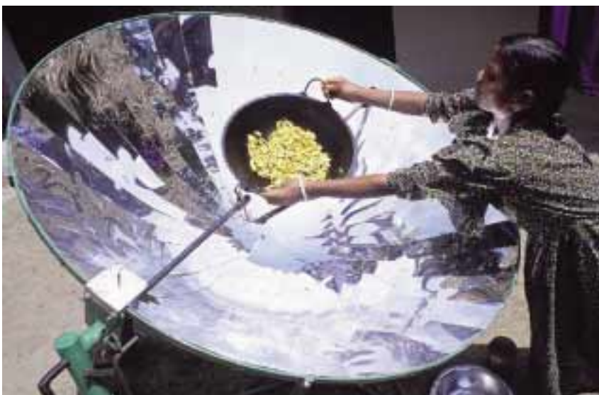
Une cuisinière solaire à Assam, en Inde. L'énergie solaire est concentrée sur la casserole. L'utilisation d'énergies non polluantes et renouvelables empêche les maladies respiratoires dues à l'usage de bois de chauffage ou de résidus de récoltes, à l'intérieur des habitations, qui sont la cause de nombreuses maladies et de beaucoup de décès dans les pays en développement. © Mark Edwards / Still Pictures
