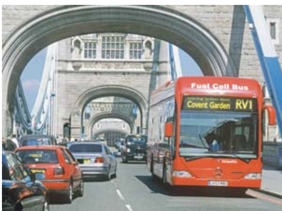
© Martin Bond / Still Pictures 已投入使用的氢燃料电池驱动的电动公共汽车正在穿过伦敦塔桥。 “欧洲清洁都市交通”示范项目在欧洲9个城市对该类型的27辆无污染公交车进行测试。
